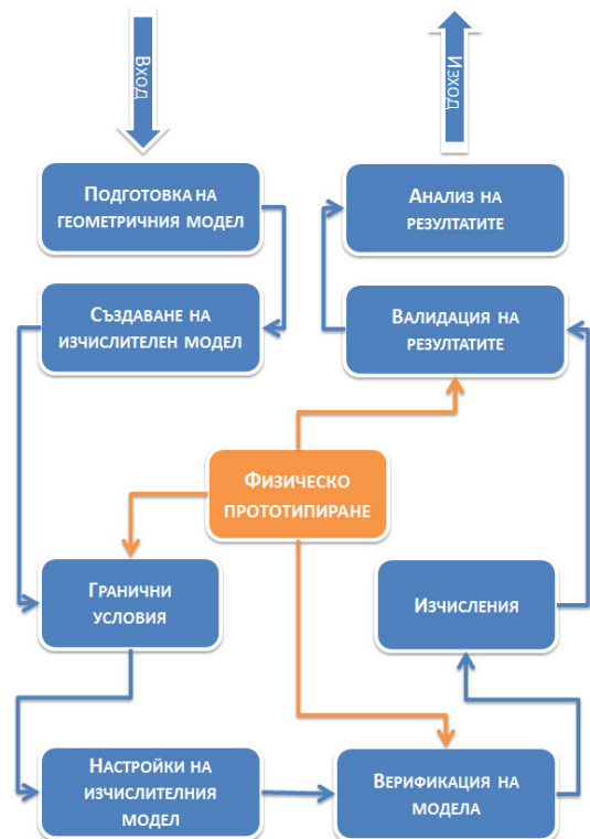
Фиг. 1 Етапи на изграждане на модел на провеждане на инженерен анализ и място на физическото прототипиране
