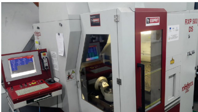
röders ESPRIT RXP 500 DS – 3-осен HSC фрезови център
