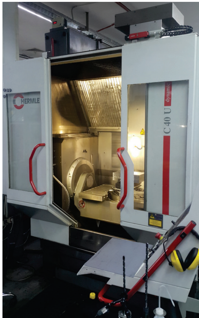
Универсален високо производителен обработващ център Hermle C 40 U dynamic.
