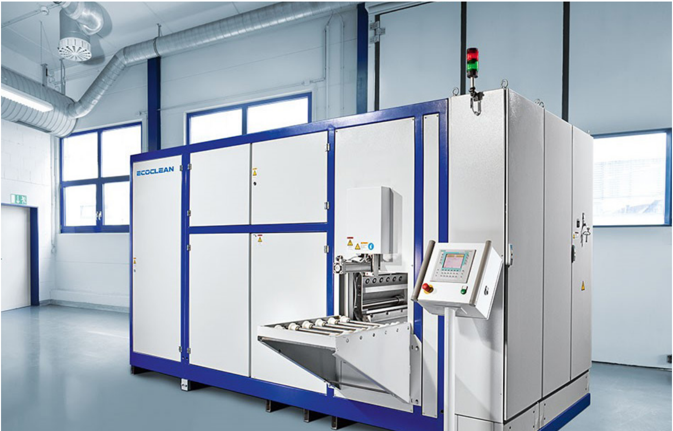
За почистване на замърсявания на основата на минерални масла, като масла и смазки, почистването с разтворители обикновено е правилното решение. Universal 81C предлага оптимални почистващи резултати, висока екологичност и ниски производствени разходи.
