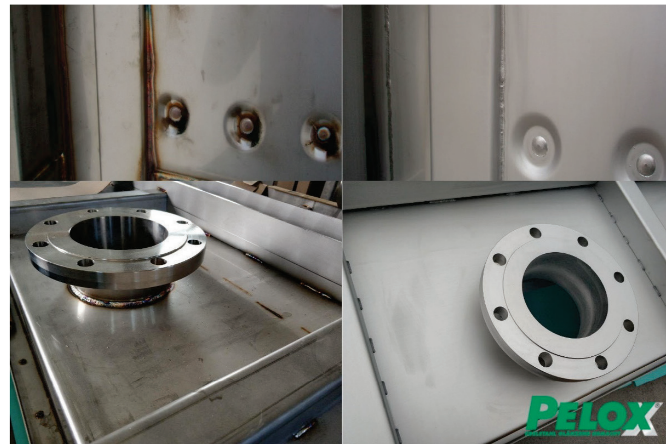
Видимо подобрение на повърхностите след обработка с продуктите на Pelox
