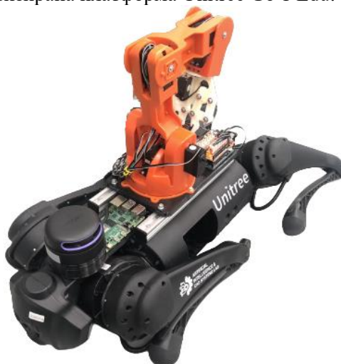
Фиг. 10 Unitree Go 1 EDU с монтирани приспособления и допълнителни елементи
